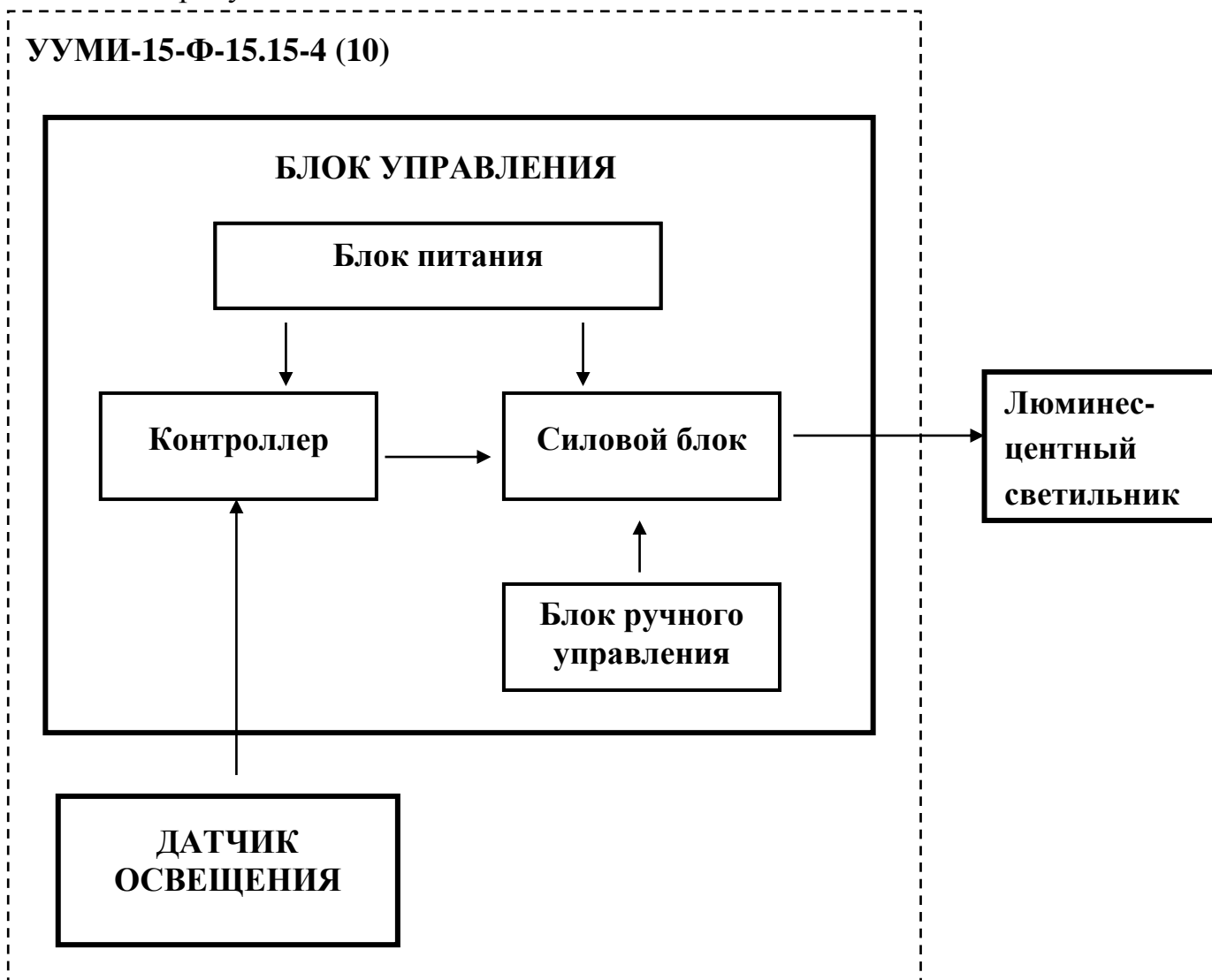
Рисунок 1.4 - Структурная схема устройства
